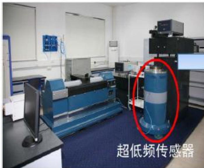
超低频水平和垂直振动基准装置
